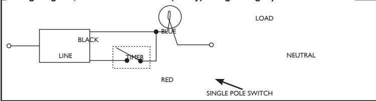
**Wiring diagram, 3 switch installation:**
